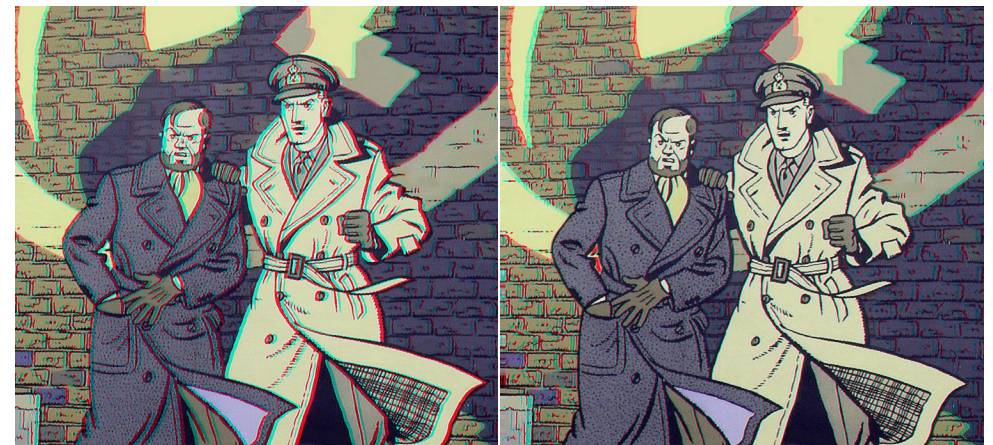
Anaglyphes obtenus avec carte de profondeur, à gauche dans SPM (méthode 3) et à droite dans PS (méthode 2). A priori, pas de différence entre les deux images. Mais en grossissant fortement sur écran on s'aperçoit que SPM a épaissi le contour des personnages sur leur droite, sans doute une conséquence de la nécessité de remplir (même faiblement) l'absence, due à la parallaxe, d'éléments d'image sur le mur.
