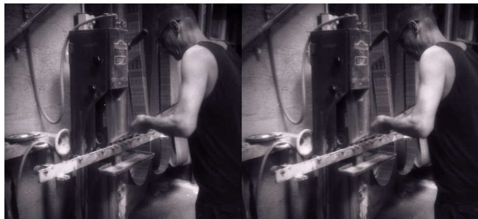
Polissage du chant d'une plaque de verre - Photo : Émilien Baudeau
